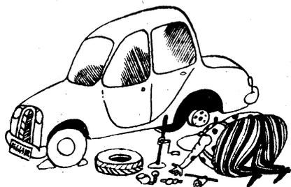
На автомобилях ВАЗ, где в двигателях установлен ремень, операция также проста, только вместо пусковой рукоятки следует пользоваться специальным ключом или включить высшую передачу и провернуть коленчатый вал колесом (рис. 6).
