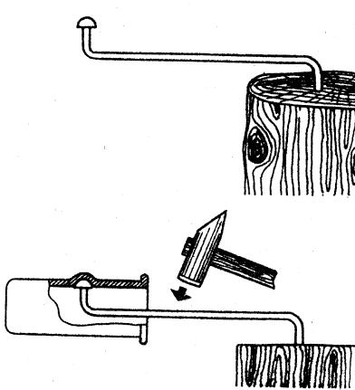
Рис. 4. Чекан-трещотка и приемы обработки стенок сосуда изнутри
