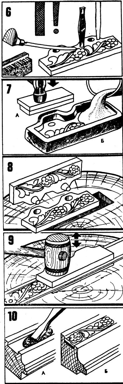
Рис. 1. Последовательность выполнения басменного рельефа: 1 — эскиз раппорта багета, изготовление по нему модели; 2 — изготовление гипсовой формы по модели [А] и по готовому багету [Б]; 3 — отделение гипсовой модели матрицы; 4 — формовка и извлечение модели из опоки; 5 — заливка формы металлом [получение матрицы]; 6 — проработка деталей матрицы; 7 — изготовление пuhanсона штамповкой [А] и отливкой [Б]; 8 — способ закрепления матрицы; 9 — тиснение басменного узора; 10 — крепление басмы на багете
