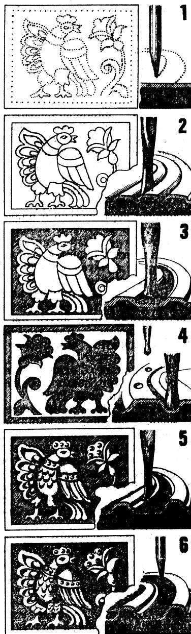
На этой стадии разными чеканами нужно проработать все детали, включая самые мелкие, уточнить расходником контуры фона и отдельных элементов узора.
