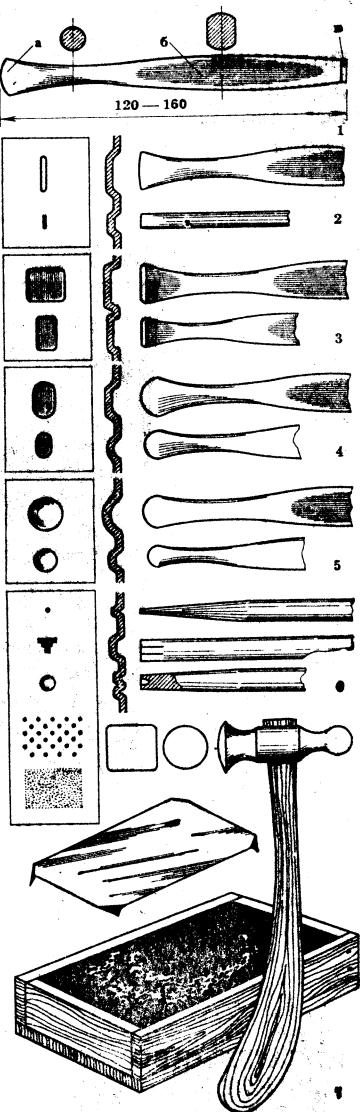
сферическим выколачивают крупные элементы рельефа. Ручку молотка делают из древесины твердых пород, придая ей изогнутую форму с утолщением на конце.
