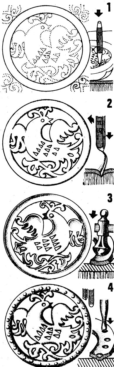
Рис. 6. Последовательность выполнения просечного декора фонаря:
