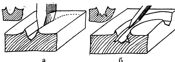
мается. Чтобы повысить прочность вставных элементов инкрустации, на дне канавки насекают острый зубильцем дополнительно две канавки (рис. 2). Одну канавку делают с наклоном вправо, другую — влево. Обработанные таким образом углубления в сечении будут представлять собой расширяющийся книзу трехзубец. Забитый в такое углубление мягкий металл благодаря этому прочно соединится с основой.
