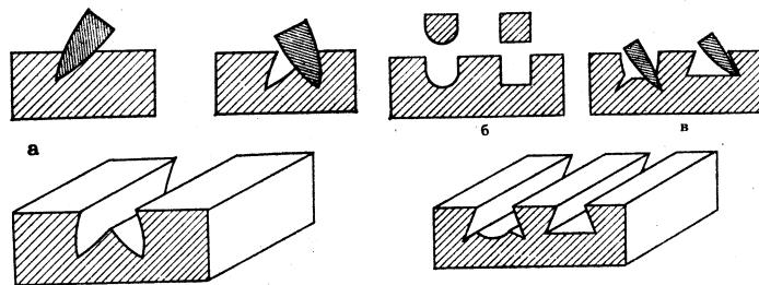
Рис. 3. Вырезание канавок гравировальными инструментами: а — гравирование шпицтихелем; б — выполнение канавок фляхтихелем; в — скашивание стенок шпицтихелем
